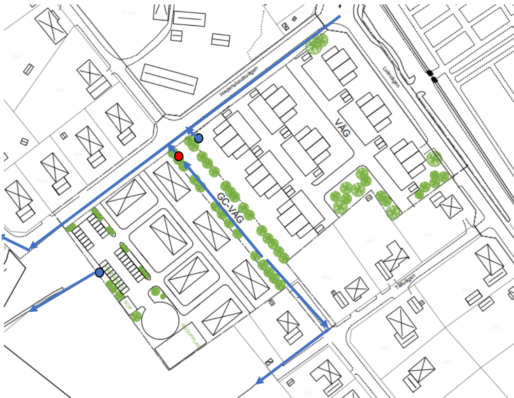
Rekommenderad dagvattenhantering. Blåa punkter - Förbindelsepunkter. Röd punkt - Kupolsilsbrunn. (Lumire)
