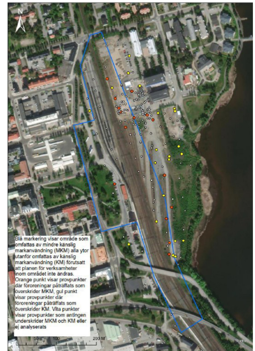
Bild 105. Sammanlagd föroreningskart relaterat till utförda provtagningar och dess förhållande till det planerade området för riktvärden KM och MKM (där området innanför blå linje redovisar markanvändning för bedömningsgrunderna MKM.)
