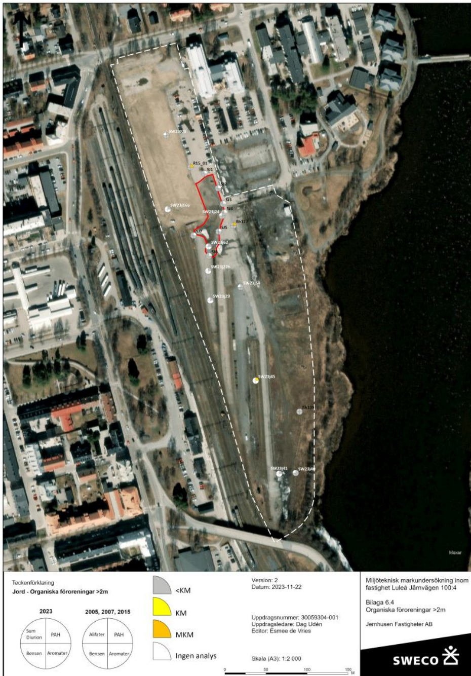
Figur 14. Lokalisering av organiska föroreningar på över 2 m djup, sammanvägning av alla undersökningar inom fastigheten Järnvägen 100:4 1. Grå markering innebär att föroreningshalten underskrider riktvärdet för KM. Gul markering innebär att föroreningshalten överskrider riktvärdet för KM men underskrider riktvärdet för MKM. Orange markering innebär att föroreningshalten överskrider riktvärdet för MKM. Vit markering innebär att föroreningen inte analyserats för. Röd linje markerar ett delområde som genomgått sanering.
