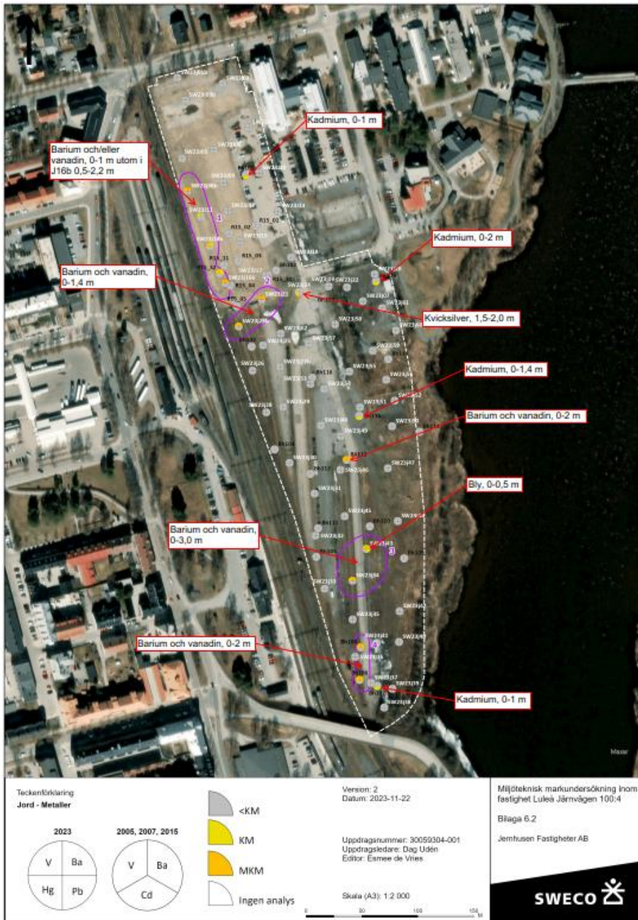
Figur 15. Lokalisering av metallföreningar på under 2 m djup, sammanvägning av alla undersökningar inom fastigheten Järnvägen 100:4 1. Grå markering innebär att föroreningshalten underskrider riktvärdet för KM. Gul markering innebär att föroreningshalten överskrider riktvärdet för KM men underskrider riktvärdet för MKM. Orange markering innebär att föroreningshalten överskrider riktvärdet för MKM. Vit markering innebär att föroreningen inte analyserats för.
