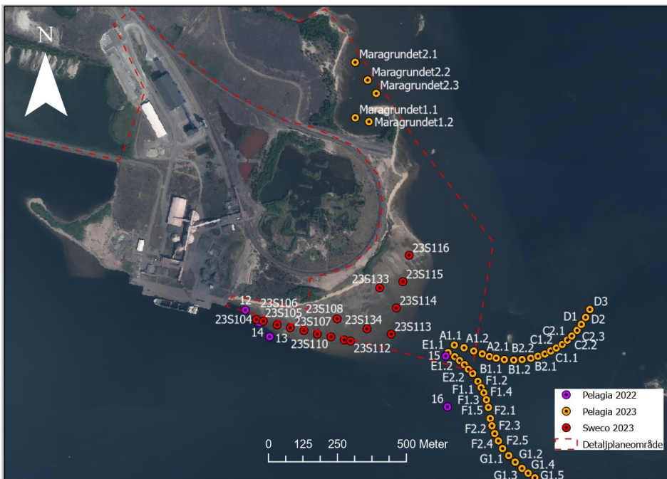
Figur 6-3. Provtagningspunkter för sediment inom planerat muddrings- och utfyllnadsområdet vid Svartön.
