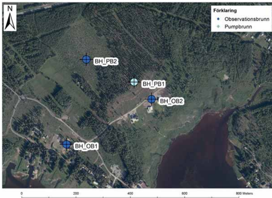
Figur 2 Pumpbrunn samt observationsbrunnar i Börtnäsheden
