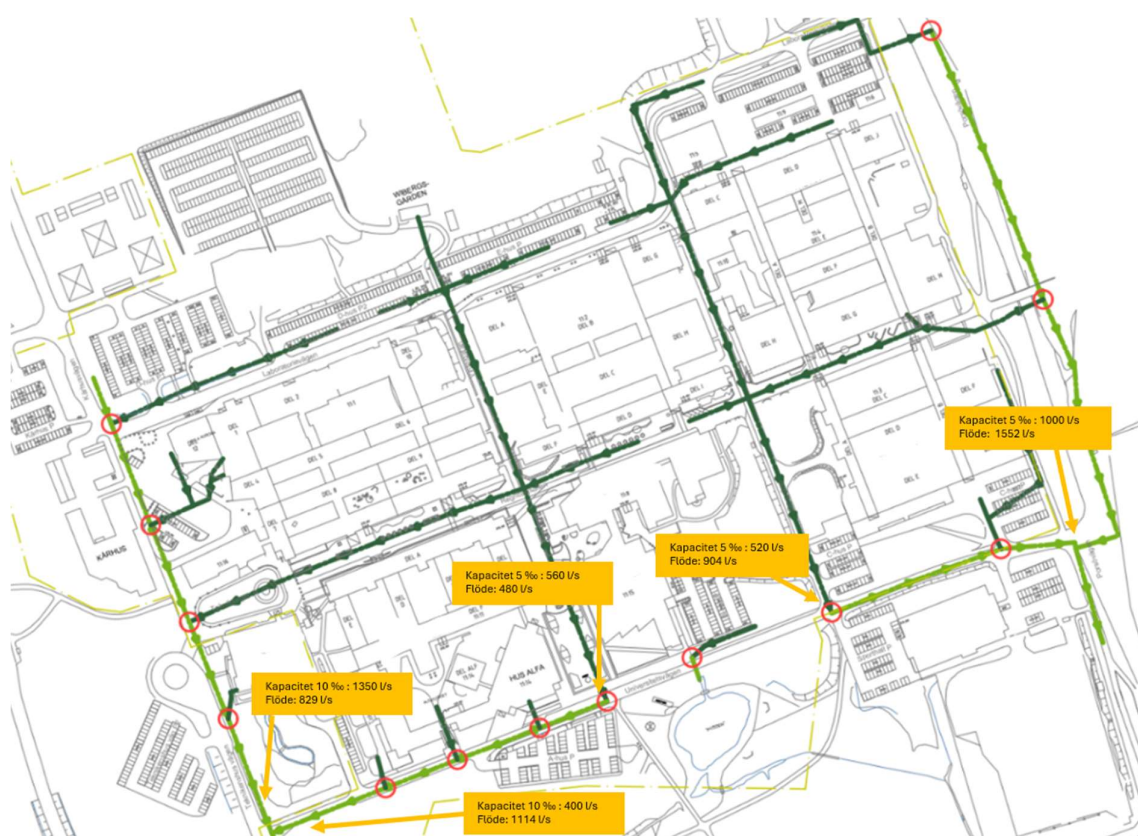
Figur 12. Uppskattad kapacitet och belastat flöde för utsatta bryt- och förbindelsepunkter.
