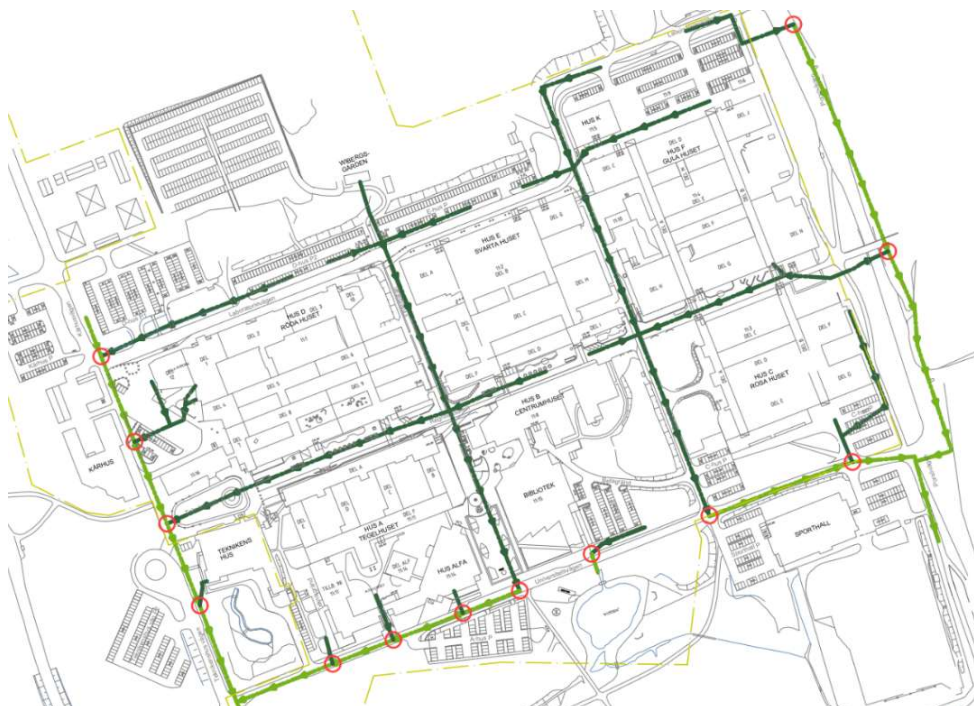
Figur 6. Befintligt huvudstråk för dagvattenledningar inom området med förbindelsepunkter, röda cirklar.
