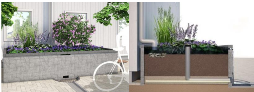
Figur 6.6-3 Exempel på upphöjd regnbädd som tar emot dagvatten från tak via stuprör (T. Lindfors, 2014)
