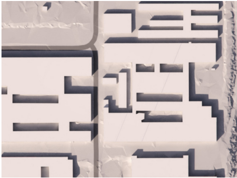
KL 13.00 Figur 29. Vår/höstdagjämning, befintlig bebyggelse
