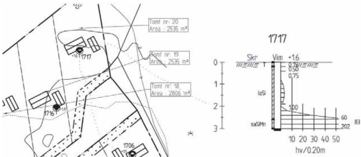
Figur 2 Utklipp från plan- och löspunktsritning med utförda undersökningar på aktuell tomt
