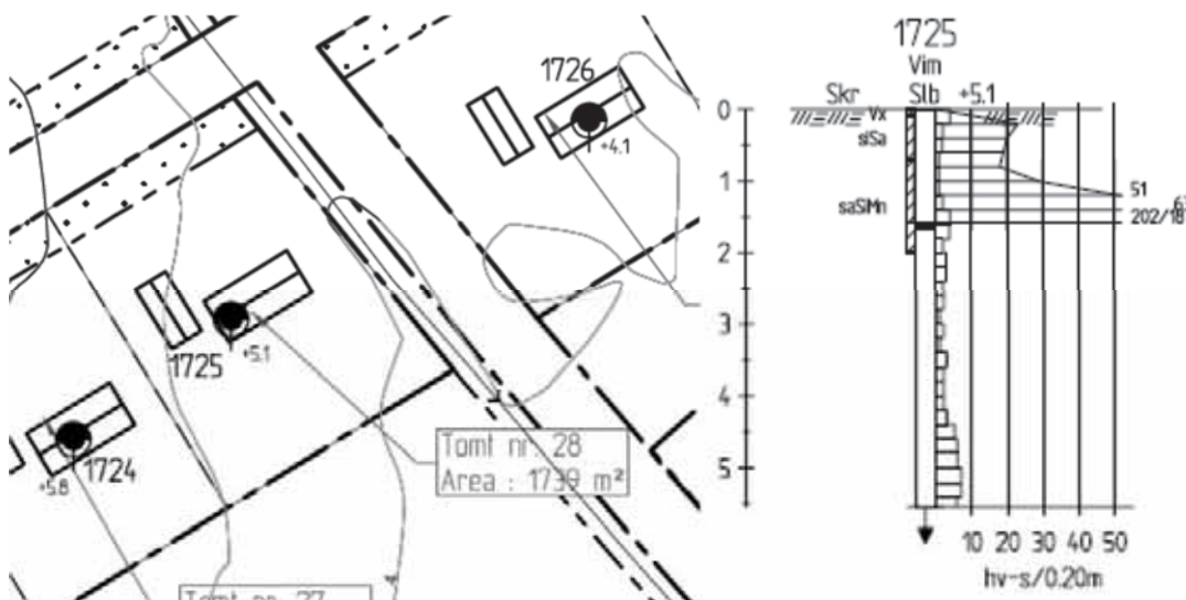
Figur 2 Utklipp från plan- och löspunktsritning med utförda undersökningar på aktuell tomt
