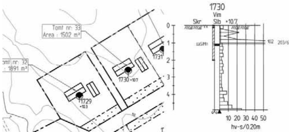
Figur 2 Utklipp från plan- och löspunktsritning med utförda undersökningar på aktuell tomt
