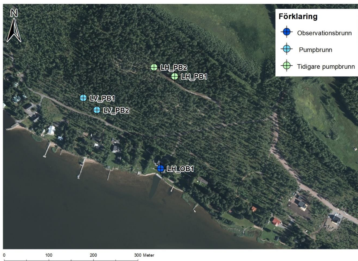
Figur 2. Pump- och observationsbrunnar i Lillviken, Luleå. Brunnarna LH_PB1 och LH_PB2 installerades och provpumpades 2017. Brunnarna gav inte tillfredsställande resultat och 2018 installerades två ersättningsbrunnar, LV_PB1 och LV_PB2.
