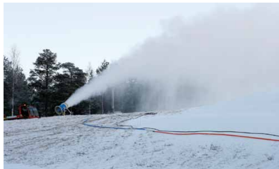
Idag måste det vara minst tio grader kallt för att man ska kunna tillverka snö. Projektet Snö och is kommer förhoppningsvis få fram lösningar så att man kan spruta snö även vid varmare temperaturer.
