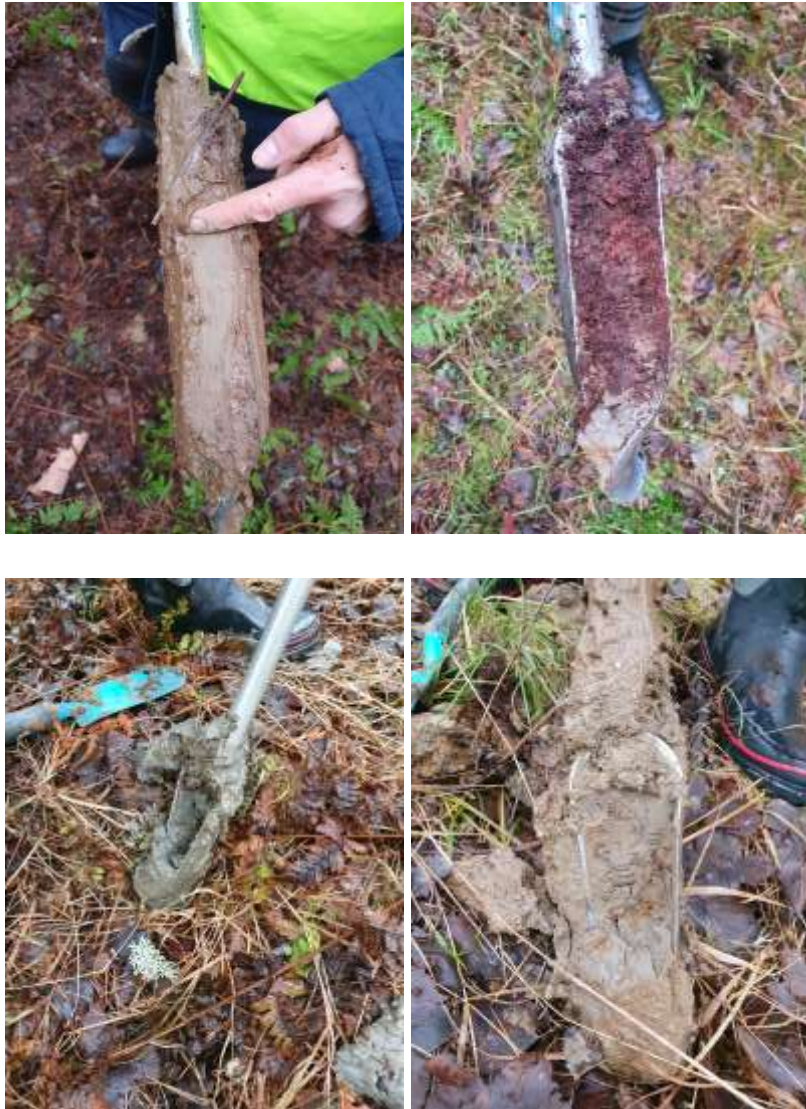
Figur 7 Överst till vänster: Typiskt jordprov som domineras av siltfraktion. Överst till höger: Växtskikt och underliggande siltigt material. Underst till vänster: Silt med inslag av rost. Underst till höger: Lerig silt med rostinslag.
