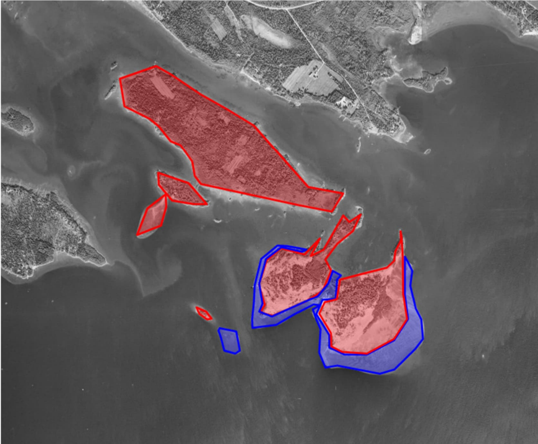
Figur 3-1. Området markerat med rött visar naturlig holme som främst består av morän. Blå markering visar grunt vattendjup runt naturliga holmar anno cirka 1960. Kartmaterial är offentligt och hämtat från Lantmäteriet under år 2023, https://minkarta.lantmateriet.se/ . Markeringar är ritade av Sweco år 2023.
