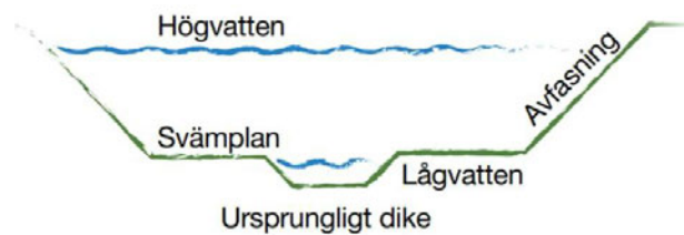
Figur 16. Exempel på svackdike (tv) och princip för tvåstegsdike (th) (Tyréns, 2024).
