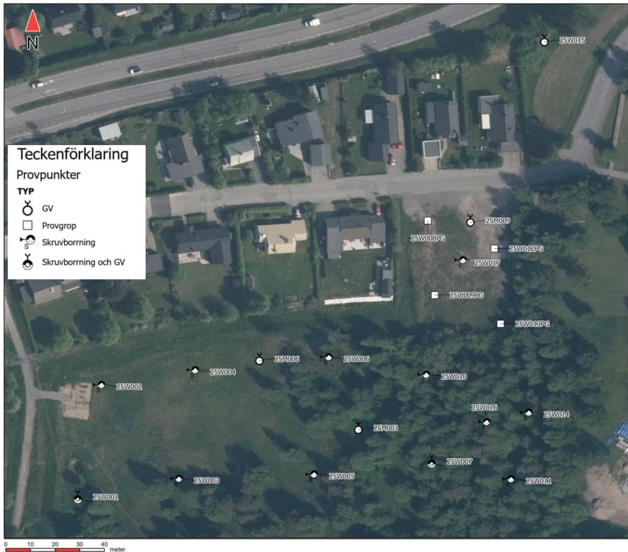
Figur 3. Provpunkternas placering för föreliggande undersökning. Kartan redovisar även tre befintliga grundvattenrör från tidigare utförd undersökning.
