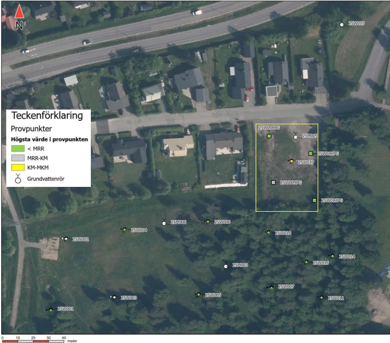
Figur 4. Provtagningspunkter i jord med klassning utefter Naturvårdsverkets generella riktvärden för förorenad mark (NV 5976). Gula färger indikerar halter över KM i ett eller flera prov. Grå färger indikerar halter mellan MRR-KM i ett eller flera prov. Gröna färger indikerar halter under MRR. Vit färg innebär inga analyserade prov. Gul rektangel illustrerar utfyllt område var det har påträffats enstaka halter överskridande KM i föreliggande samt tidigare utförd undersökning (Mitta, 2025).
