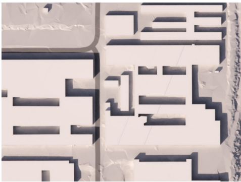
KL 13.00 Figur 29. Vår/höstdagjämning, befintlig bebyggelse
