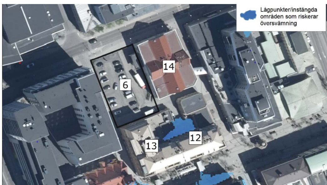
Bild 30. Befintliga lågpunkter/instängda områden som riskerar att översvämmas vid stora regn.
