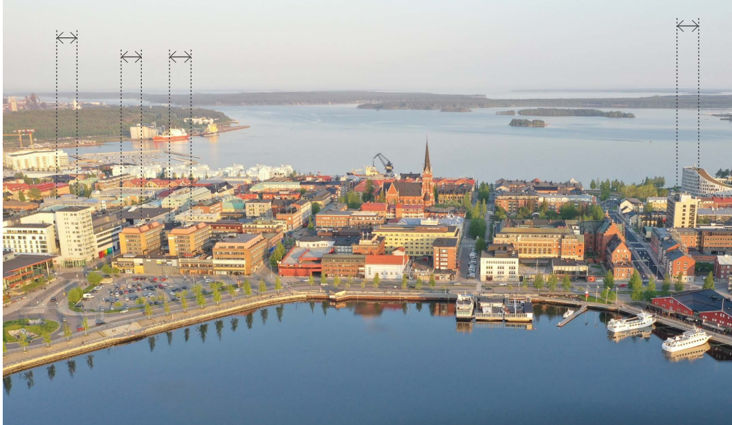
Bild 18. Stadsbilden över Norra hamn har ett gemensamt gavelmotiv för uppstickande byggnadsvolymer där gavlarna vetter mot norr och söder med ungefär 15 meters bredd eller något smalare. Foto: Magnus Stenberg.
