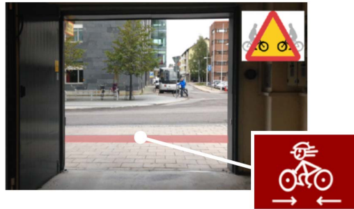
Bild 24. Exempel på hur gestaltningen av gång- och cykelbanan och skyltar kan medverka till att uppmärksamma bilarna som ska ut från garaget. Bild av RK Trafikkonsult.
