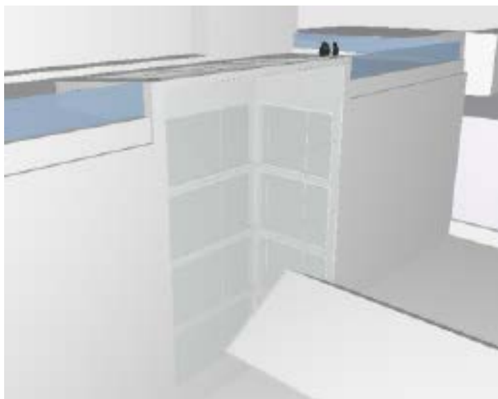
Bild 40. Dagsljussimuleringen undersöker hur ett atrium vid den östra fasaden bidrar till att uppfylla dagsljuskraven på våning ett till sex i byggnaden som planförslaget medger.
