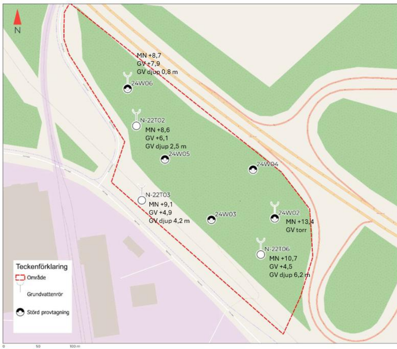
Figur 7. Provtagningspunkter och uppmätta grundvattennivåer. Bakgrundsbild från PM markmiljö (WSP, 2025)
