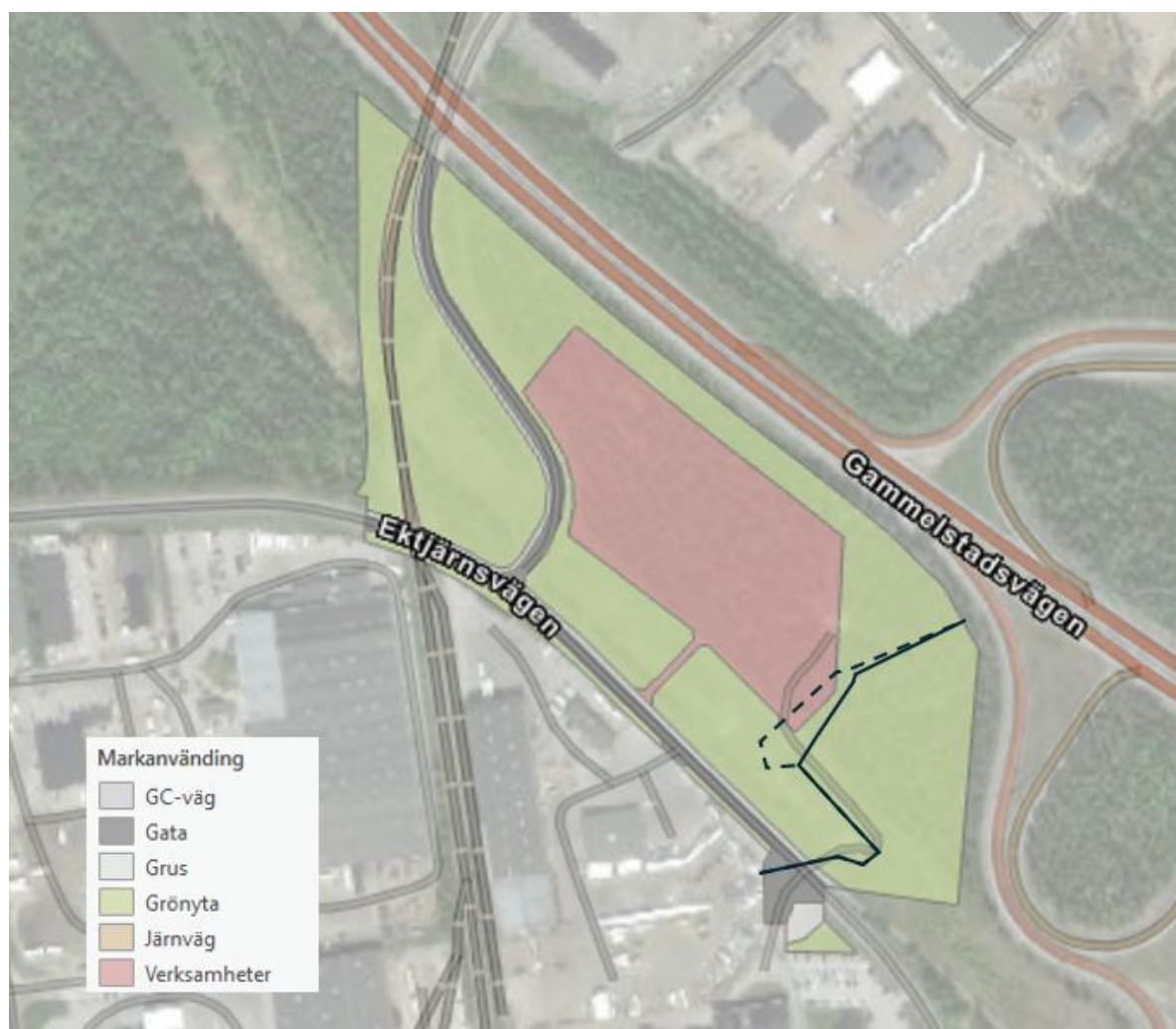
Figur 11. Planerad markanvändning inom planområdet. Planområdesgräns i blått. Streckad linje redovisar ungefärlig gräns för avrinningsområdet till ledningsnätet vid befintliga förhållanden och heldragen linje visar ungefärlig gräns vid framtida förhållanden.
